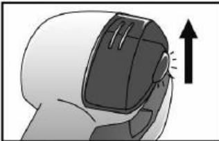
①水タンクのサイドにあるボタンを上押し、ロックを解除します。
